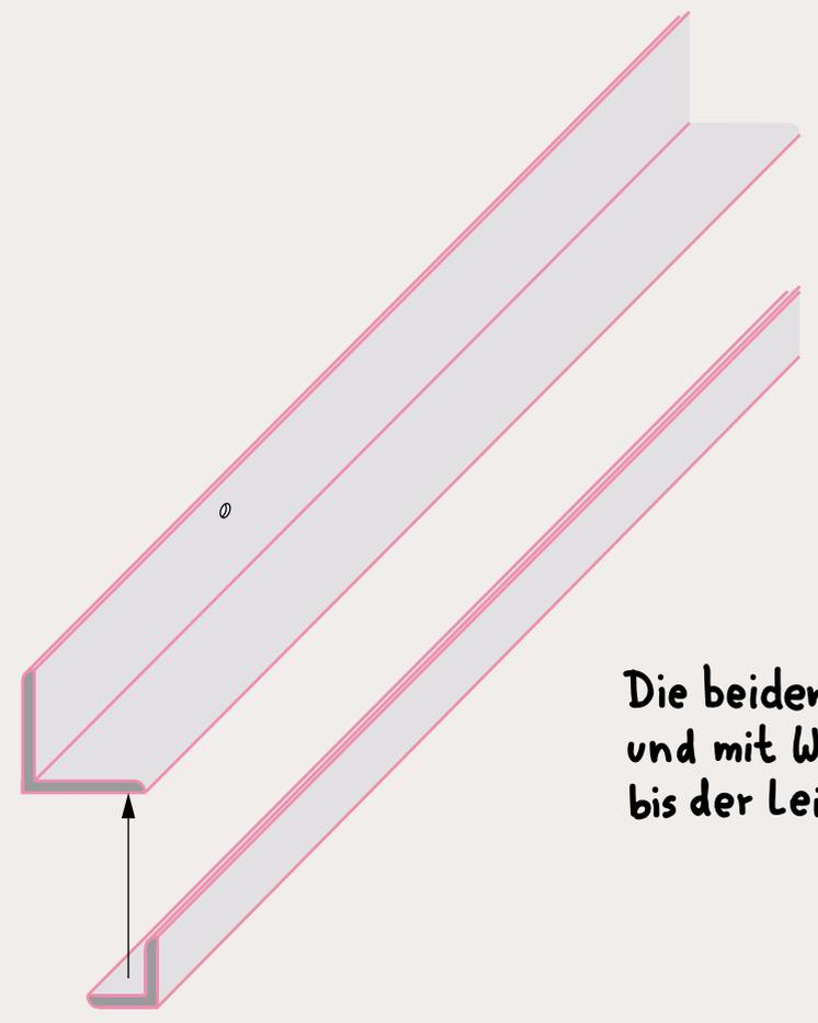
Die beiden Leisten verleimen und mit Wäscheklammern fixieren, bis der Leim getrocknet ist
